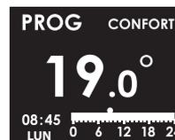
L'appareil fonctionne sur une plage Confort.
