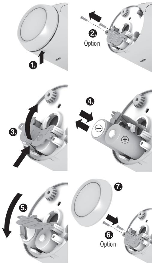
1. Enlever la molette de réglage. Pour ce faire, presser sur la rainure à la face inférieure de l'appareil.
