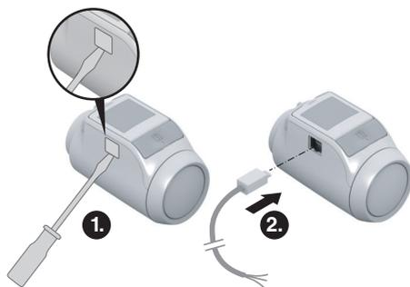
1. Retirer le recouvrement latéral de la tête programmable de radiateur.
