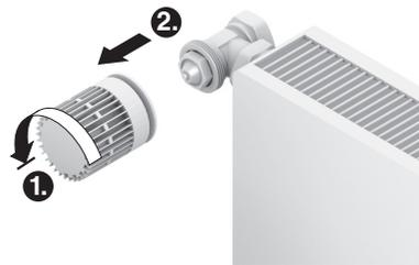
1. Tourner l'ancienne tête thermostatique vers la gauche jusqu'à la butée et desserrer la fixation.
