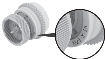
2. Pour les vannes de radiateur M28 x 1,5 (Comap): sélectionner la tête de vanne M28 x 1,5 fournie séparément. Pour toutes les autres vannes de radiateur, sélectionner la tête de vanne préalablement séparée M30 x 1,5.
