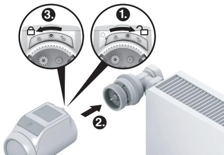
1. S'assurer que le coulisseau de verrouillage de la tête programmable de radiateur est en position ouverte.
